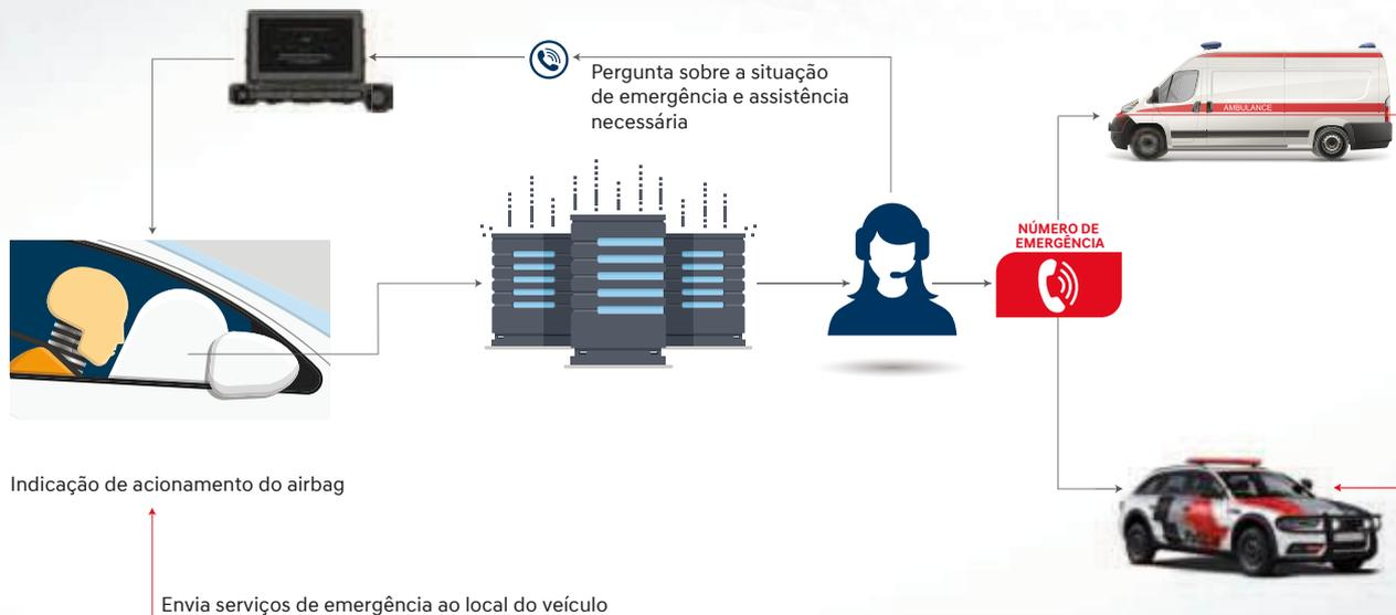
Pré-condição: Para que essa funcionalidade aconteça, a comunicações da rede do celular, do carro e do Sistema Operacional do Bluelink precisam funcionar com total cobertura. Caso uma dessas conexões fiquem intermitentes a ligação para a central poderá não ser completada.
