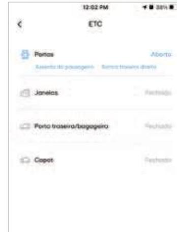
Detalhamento da situação das portas e vidros do veículo.
